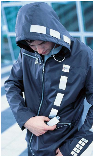
Abbildung: Wearable electronics – der Strom für den MP3-Player wird mit TEGs gewonnen. (Bildquelle: Infenion)
